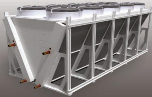
V — образные драйкулеры (сухие градирни) — представляют собой оптимальное сочетание трубчато-оребрённых теплообменников, высокоэффективных вентиляторов и конструкции корпуса. Это все позволяет обеспечить максимальную мощность по отношению к размерам оборудования.
